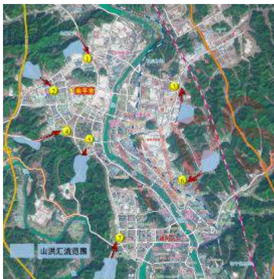
山水汇入城市雨水系统点位
